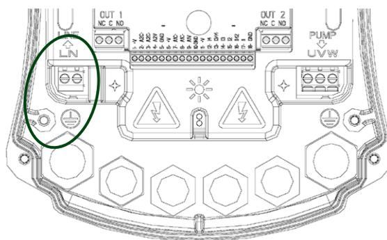
**Figura 1: Connessioni Elettriche**
