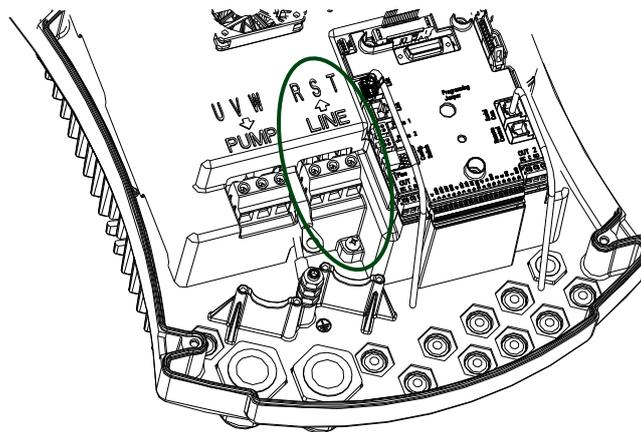
**Figura 3: Connessioni Elettriche**
