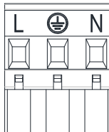
Attēls 6: Izņemams barošanas spaiļu panelis
