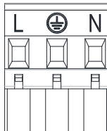
6 pav. Ištraukiama maitinimo gnybtų dėžutė
