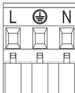
Abbildung 6: Abnehmbares Klemmenbrett der Versorgung
