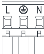
Figura 6: Morsettieria estraibile di alimentazione
